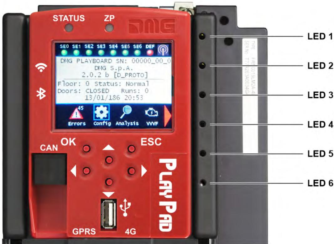
Auf der Hauptplatine befinden sich 6 Leds für eine einfache Diagnose:
