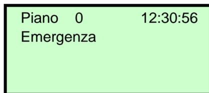
La carica delle 2 batterie della scheda di Emergenza viene testata ogni 24h. In caso di batterie scariche, viene emesso un segnale acustico di errore.
