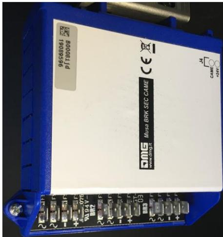
Scheda elettronica per precablaggio ponti raddrizzatori per catena sicurezze, freno/valvole e pattino retrattile.
